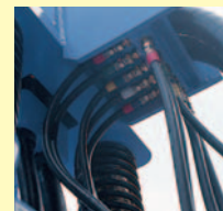
偏心モーメント制御配管部
