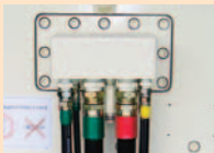
油圧ホース接続部
